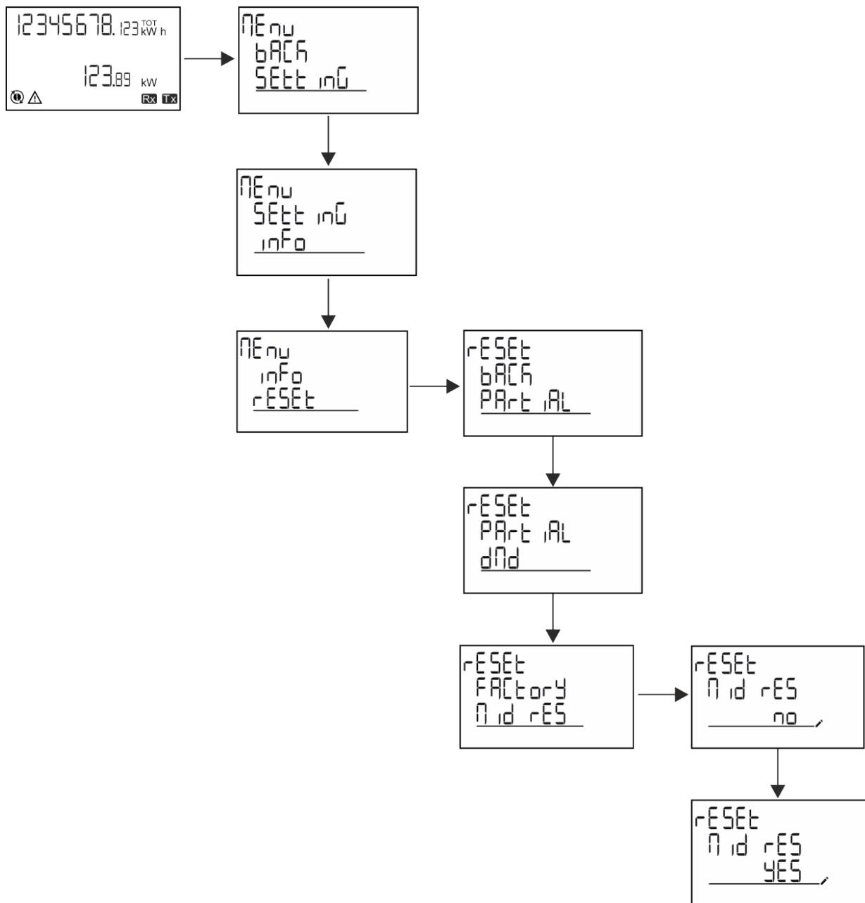
**Remarque :** dans les modèles MID, la réinitialisation ne peut être effectuée que si le compteur d'énergie n'a pas dépassé 1 kWh. En cas de mauvais réglages, vous pouvez alors corriger les erreurs de réglage du transformateur de courant CT (rapport CT), en réactivant le menu de programmation MID.
